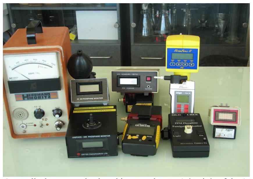
Appareils de mesure de phosphine pour basses (sécurité et fuites) et hautes concentrations (efficacité)
